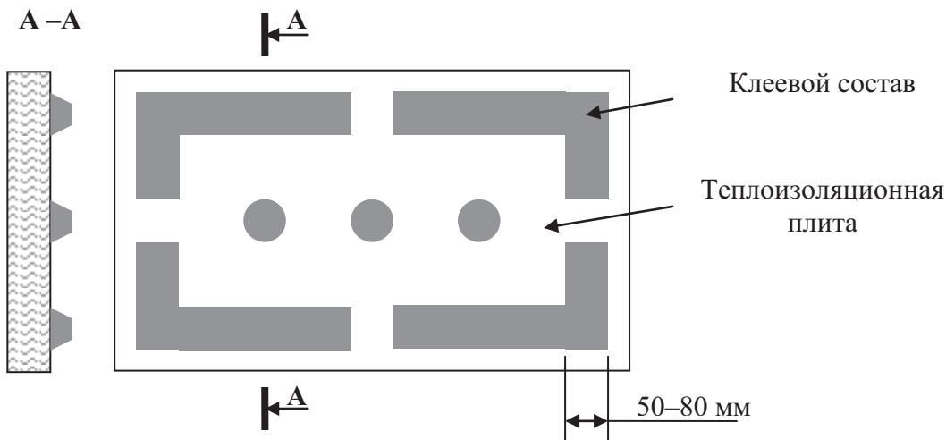
Рисунок 2 – Схема примера нанесения клеевого состава
