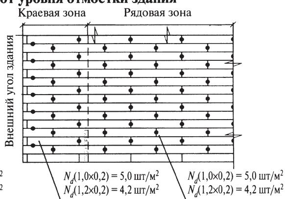
Рисунок 4 – Схемы установки тарельчатых дюбелей
