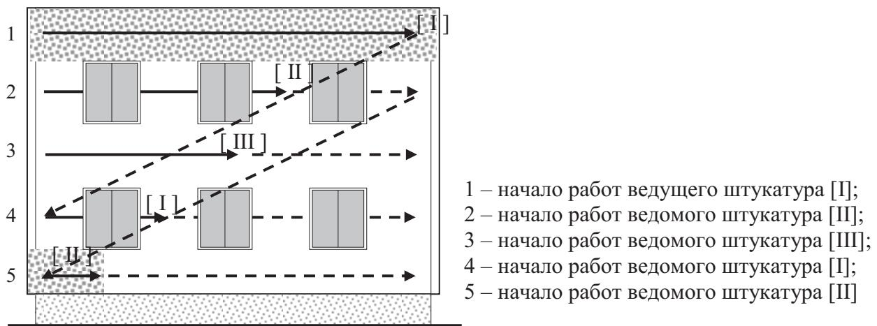
Рисунок 7 – Горизонтально-нисходящая схема устройства
