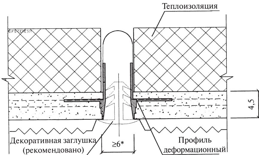
\* Ширина деформационного шва СФТК, выполняемого на протяженных участках стен, должна составлять не менее 6 мм.
