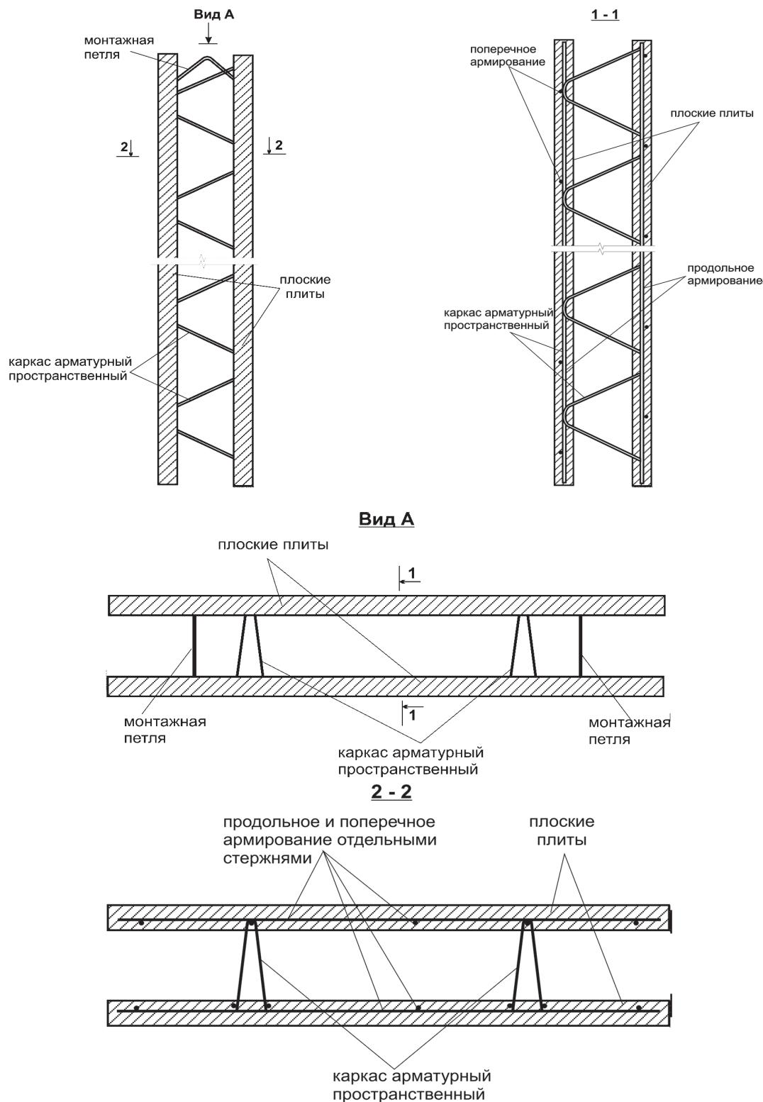
Рисунок 1 – Элемент несъемной опалубки стен
