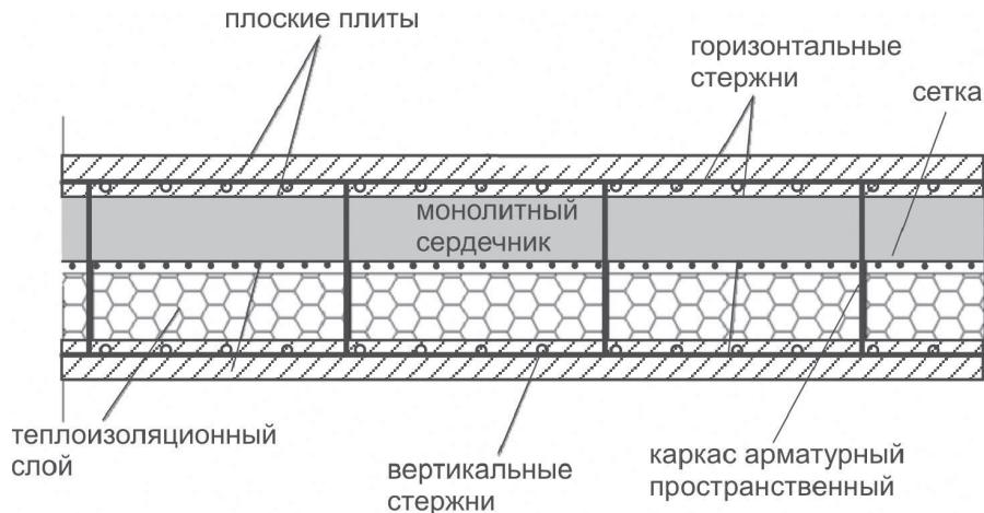
Рисунок 3 – Элемент несъемной опалубки трехслойной наружной стены
