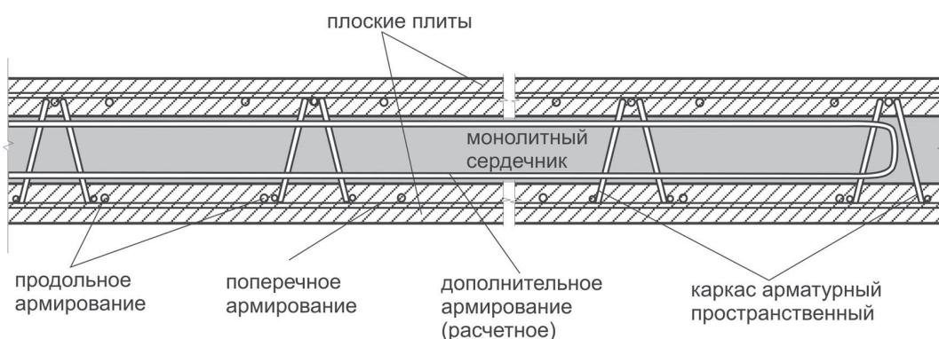
Рисунок 2 – Конструкция сборно-монолитной стены
