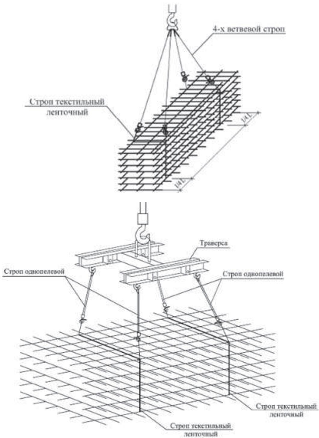
Рисунок Н.2 – Схема строповки пакета плоских сеток
