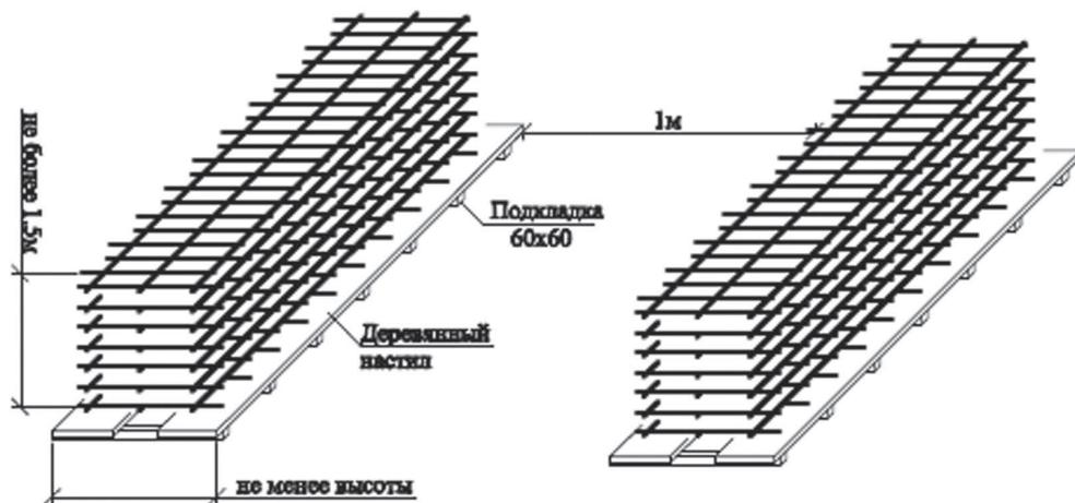
Рисунок Л.1 – Складирование пакетов плоских сеток
