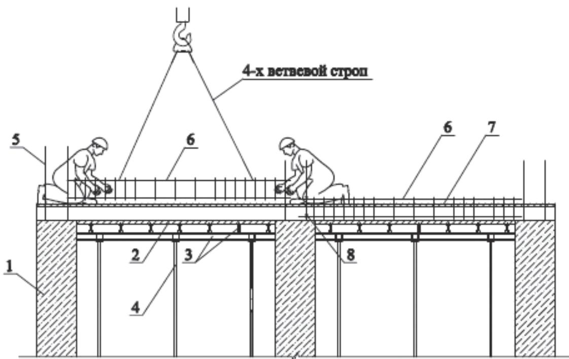
1 – колонна; 2 - опалубка балки; 3 – балка опалубки; 4 – телескопическая стойка;
