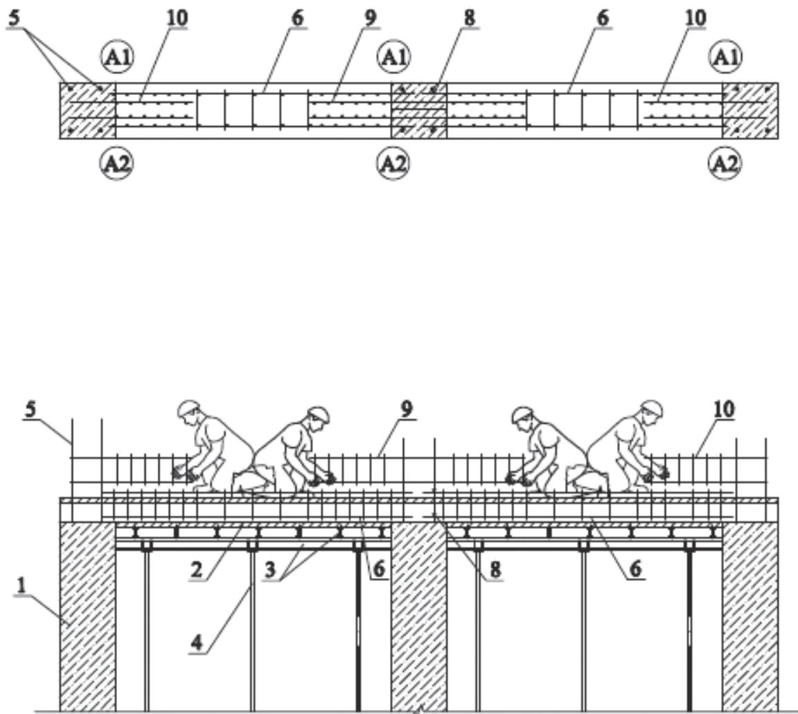
1 – колонна; 2 – опалубка балки; 3 – балка опалубки; 4 – телескопическая стойка;
