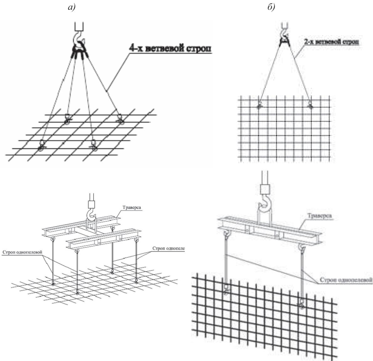
*a)* строповка в горизонтальном положении; *b)* строповка в вертикальном положении.
