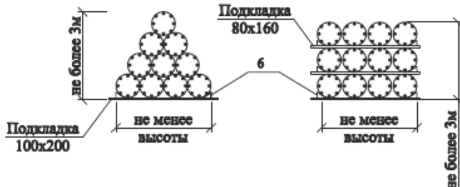
Рисунок Л.2 – Складирование объемных цилиндрических каркасов буронабивных свай
