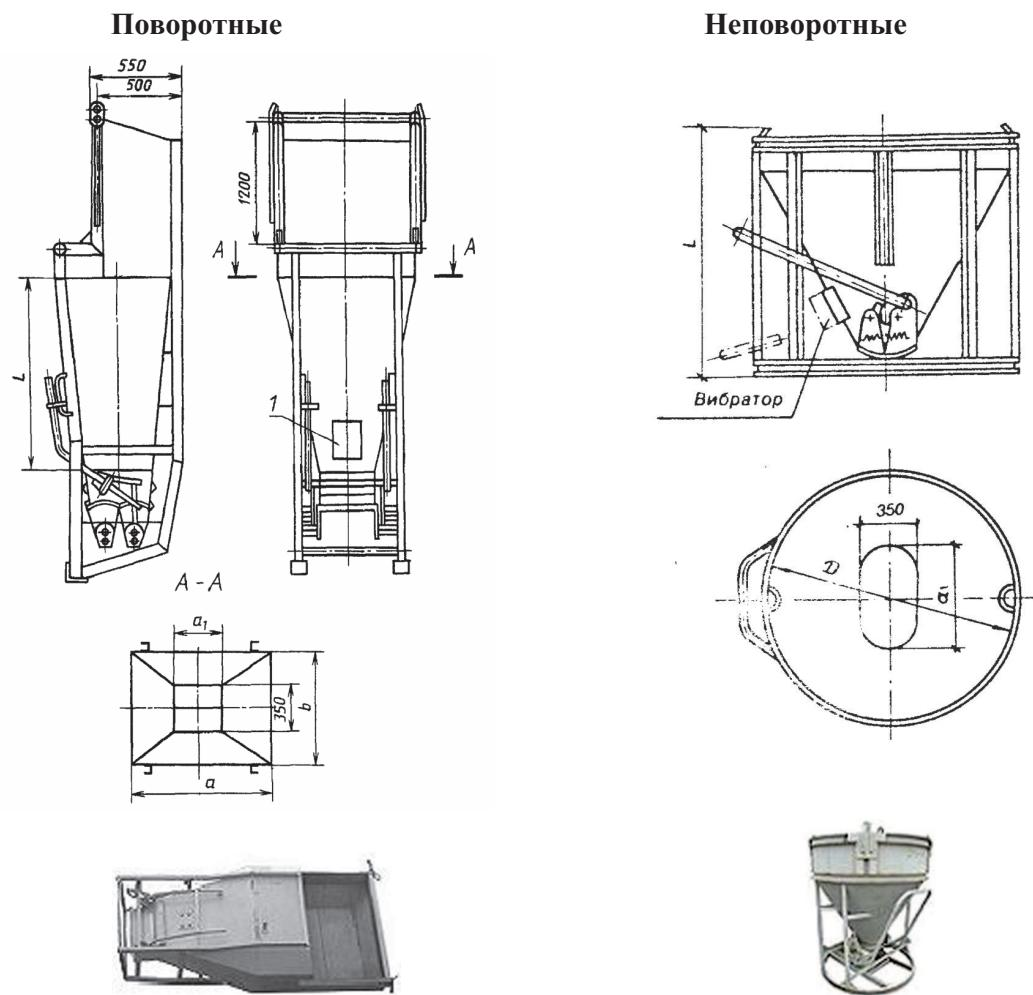
Рисунок В.1 – Бункеры (бадьи) переносные для бетонной смеси
