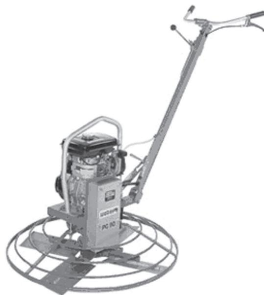
Рисунок В.5 – Затирочная машина однодисковая
